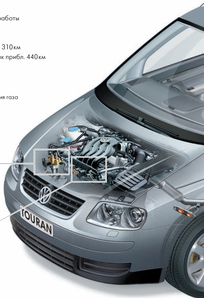
газовая распределительная магистраль с клапанами подачи газа
