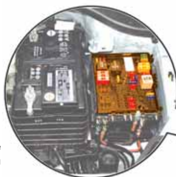
Блок предохранителей и реле в левой части моторного отсека
