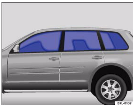
Илл. 24 Раскрывшиеся боковые занавески с левой стороны автомобиля
