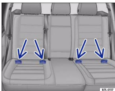
Илл. 30 Схематичное изображение: крепежные проушины на основании заднего сиденья для детского креслица ISOFIX
