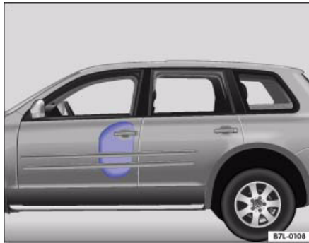
Илл. 22 Раскрывшиеся боковые подушки с левой стороны автомобиля
