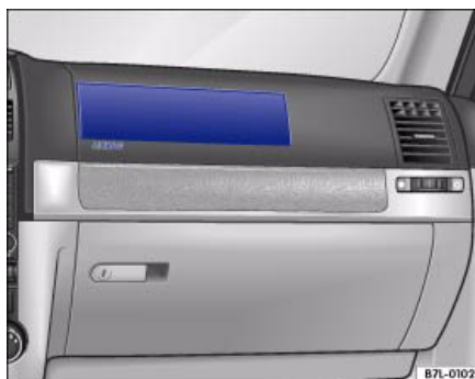
Илл. 18 Местонахождение надувной подушки для переднего пассажира: в передней панели
