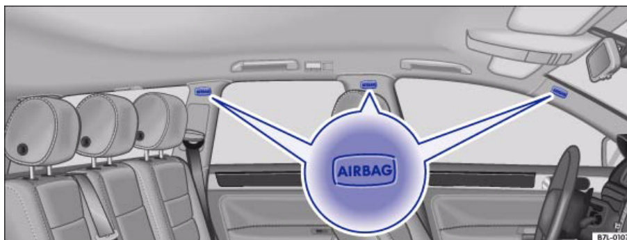
Илл. 23 Местонахождение оконных надувных подушек на левой стороне автомобиля
