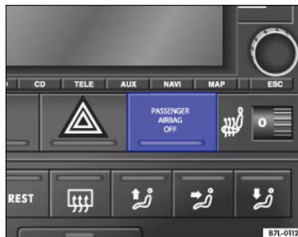
Илл. 26 Контрольная лампа отключения надувных подушек в центральной консоли
