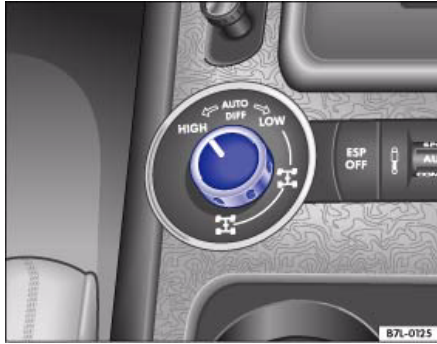
Илл. 26 На центральной консоли: поворотная кнопка блокировки межосевого и заднего дифференциалов
