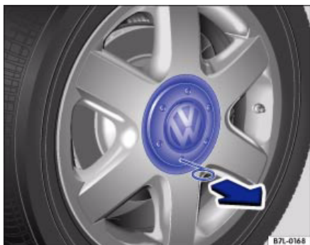
Илл. 20 Смена колеса: снятие крышки ступицы
