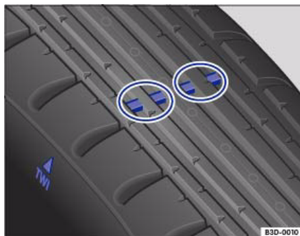
Илл. 13 Протектор шины: указатели износа
