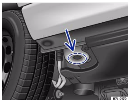
Илл. 37 Подъем автомобиля: место спереди под автомобильный подъемник
