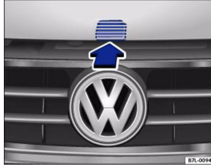
Илл. 6 Решетка радиатора: ручка для открывания капота
