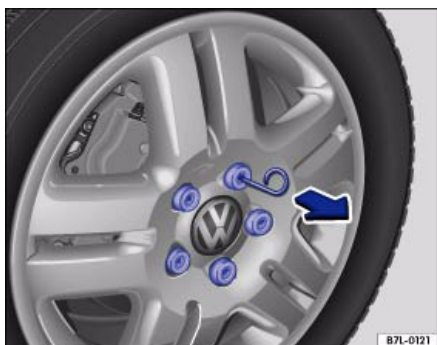
Илл. 21 Смена колеса: снятие колпачков колесных болтов
