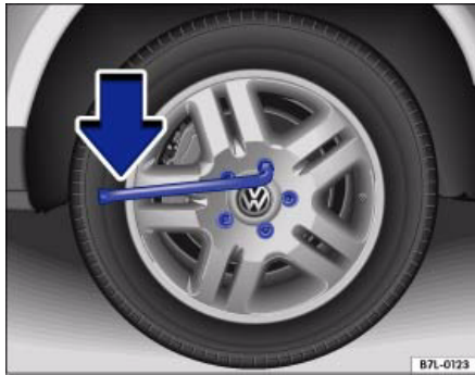
Илл. 22 Смена колеса: ослабление колесных болтов
