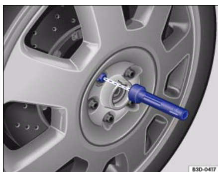
Илл. 26 Смена колеса: вывертывание колесных болтов
