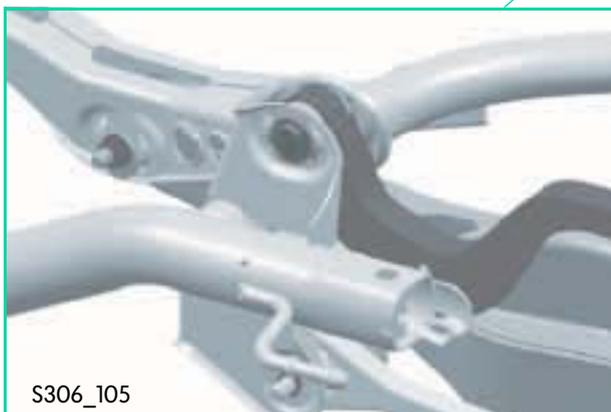
Der Sturz wird über eine Exzentrerschraube eingestellt. Diese Exzentrerschraube verbindet den Querlenker mit dem Hilfsrahmen.
