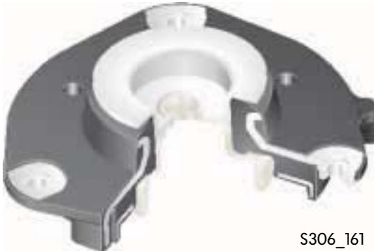
Das Federbeinlager ist ein Gummi-Metalllager. Durch die Entkoppelung der Feder- und Dämpferanbindung zur Karosserie wird die Federkraft separat in die Karosserie eingeleitet. Dadurch wird ein Vorspannen der Dämpferlagerung verhindert. Dieses beeinflusst positiv den Abrollkomfort und reduziert die Geräuschübertragung von der Fahrbahn auf die Karosserie.
